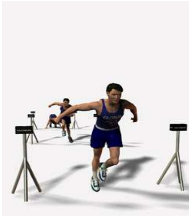
Figura 1 – Simulação de um percurso de 35 metros, usando a fotocélula para registrar o tempo durante os sprints .
